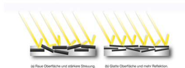
Abb. 1: Typischer Querschnitt einer herkömmlichen Silberlackierung (a) und einer PVD-Silberlackierung (b).
